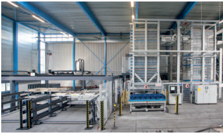
De Cromvoirtse heeft ook het sorteren van de plaatuitslagen die van de snijmachine (rechts achter het magazijn) afkomen al geautomatiseerd (links). Foto: De Cromvoirtse
